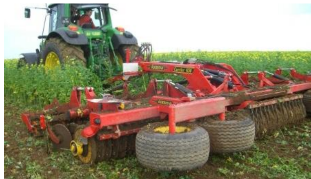
Abbildung 2: Einige Hersteller bieten bereits spezialisierte Geräte zur Zwischenfruchtzerstörung und -einarbeitung an. Hier: Kombination aus Messerwalze und Kurzscheibenegge.
