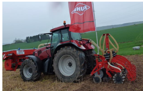
Abbildung 6: mechanische Streifenbearbeitung mit kombinierter Unterfußdüngung
