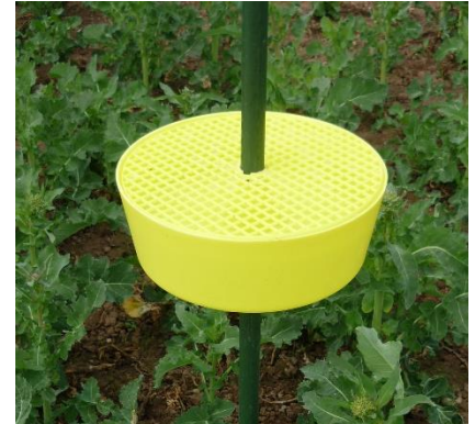
Bild 1: Höhenverstellbare Gelbschale mit Gitterauflage. Das Gitter schliesst unerwünschten Beifang aus, z.B. Honigbienen und Hummeln.
